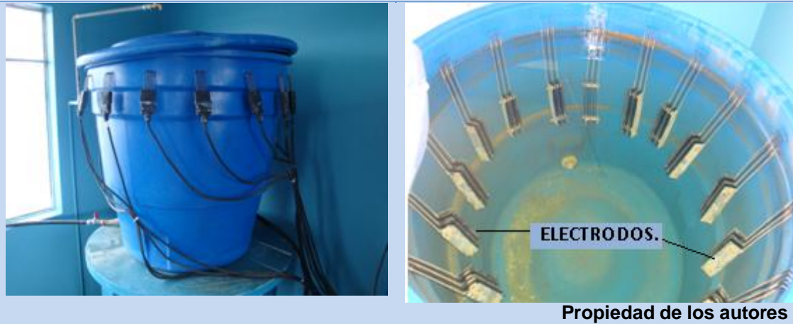
Fotografía 2.3.2.3-a Tanque empleado para la electrólisis del NaCl
