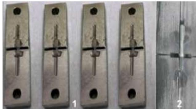
**Figura 36. 1- Monturas/Guías para micro tracción. 2- Detalle de una muestra adherida en la montura/guía de micro tracción**
