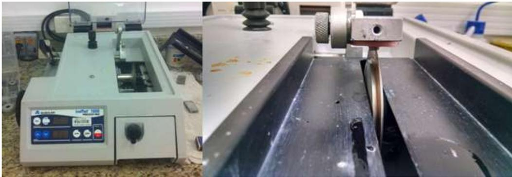
**Figura 34. Sierra de precisión BUEHLER® IsoMet® 1000 PRECISION SECTIONING SAW.** Fuente: Dr. Fernando Hanashiro
