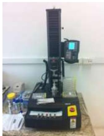
**Figura 37. Máquina de ensayos mecánicos Mini-Instron, modelo 5942**
