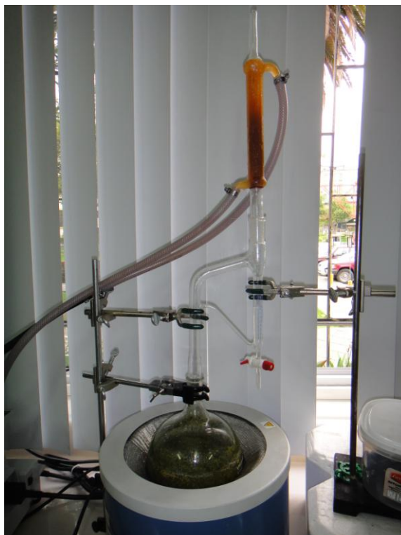
Figura 7: Proceso de destilación por arrastre de vapor utilizando una trampa tipo Clevenger.
