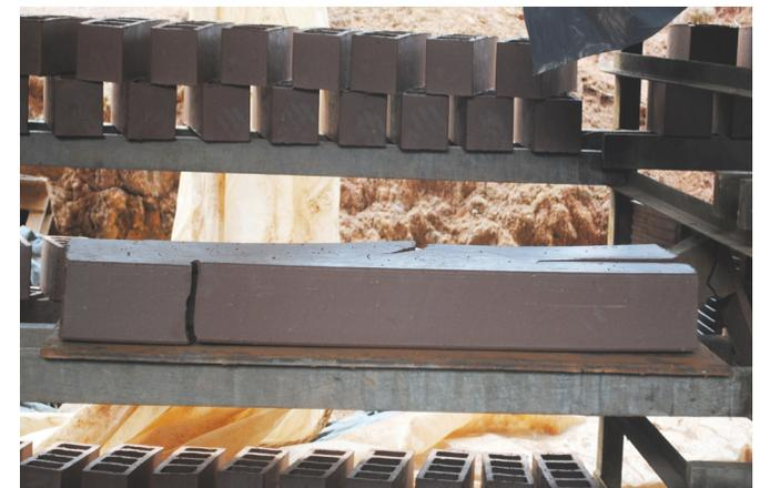
59 Rotura de pieza de arcilla de 0.97cm de longitud.
