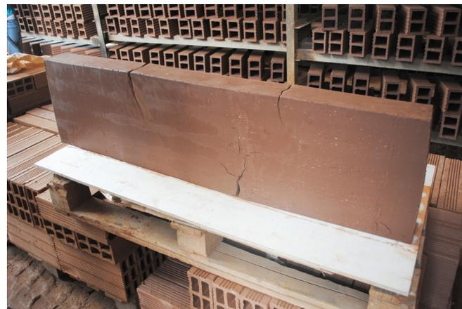
58 Rotura de pieza de arcilla de 1.20cm de longitud.
