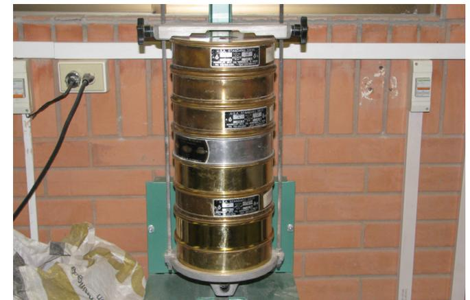
103 Máquina tamizadora del material.
