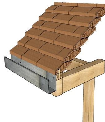
36 Perspectiva de unión de faldón piezas cerámica con solera y canal de aguas lluvias.
