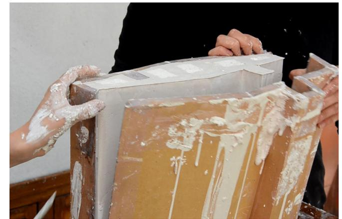
66 Desencofrado de pieza de yeso.
