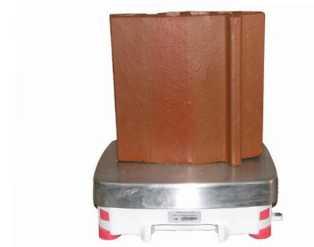
118 Pieza húmeda pesada en balanza digital
