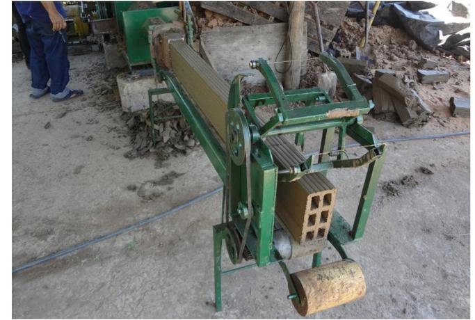
11 Moldeado del ladrillo semi-industrial mediante extrucción
