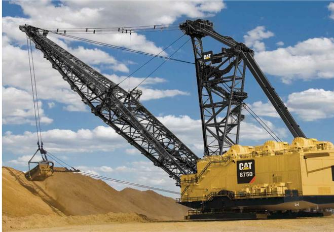
15 Selección y extracción de la materia prima mediante dragalinas para la producción
