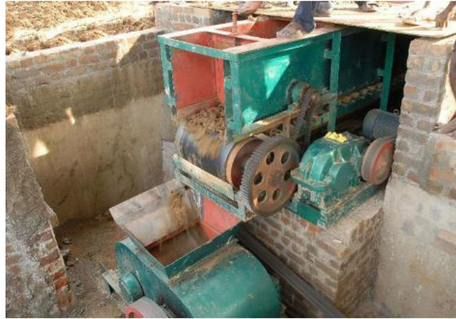
10 Preparación de la mezcla en fabricación semi-industrial
