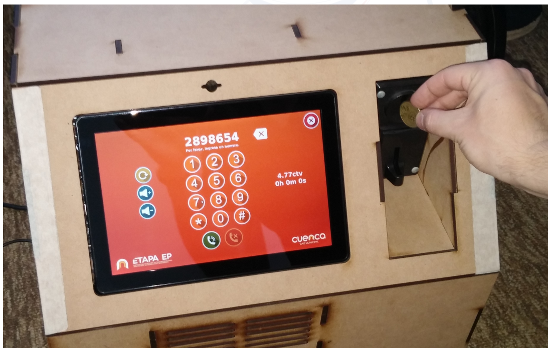
Figura 4.7: Interfaz del Teléfono implementado en el Nodo Multimedia
