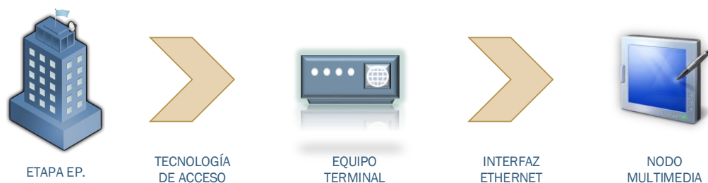
Figura 3.1: Diagrama de Acceso a la red
