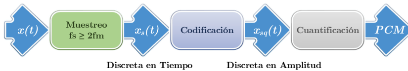
Figura 2.1: Diagrama de Bloques Digitalización de la Voz
