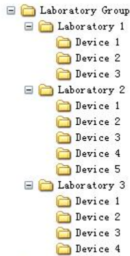
Figura 2.13: Espacio de direcciones de un servidor OPC UA [1]
