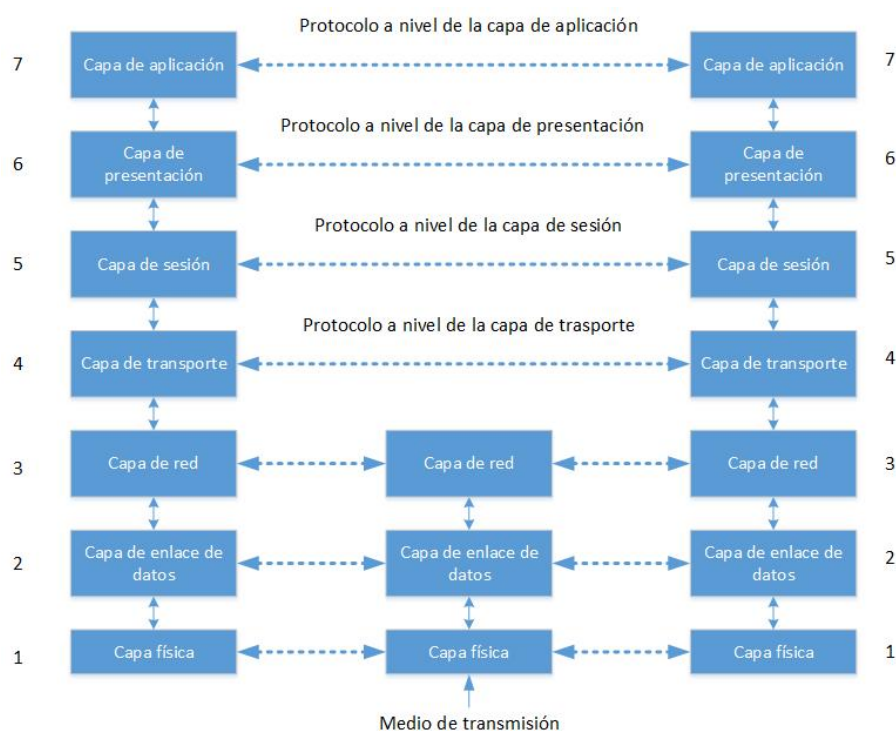
Figura 2.8: Modelo OSI, para la conexión de sistemas informáticos abiertos
