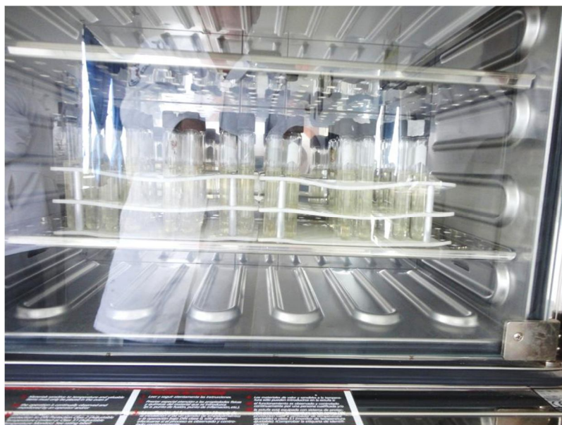
Fotografía 38: Incubación de los tubos por 24 horas a 35 ° C.
