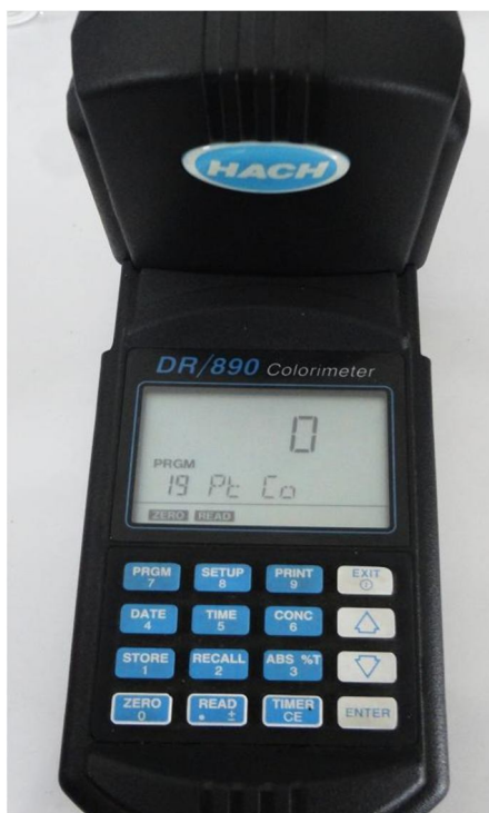
Fotografía N°28: Programación del equipo y encendido con blanco de muestra 25mL.
