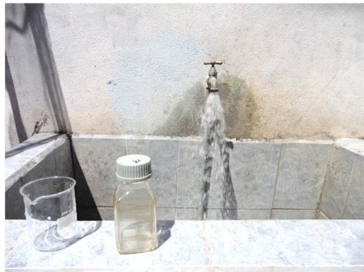
Fotografía N° 14: Corrida de agua y toma de muestra para Físico-Químico y microbiológico.
