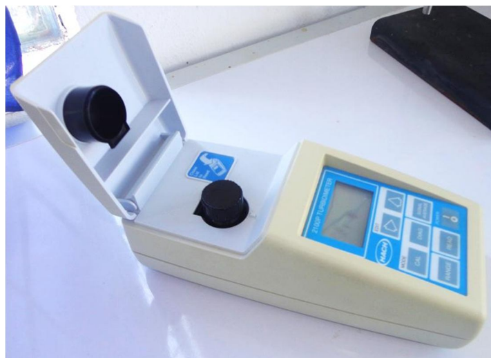
Fotografía N° 31: Encerado del equipo con blanco agua destilada (20mL)
