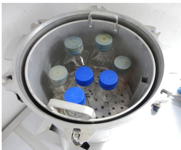
Fotografía N° 3. Autoclave para esterilizar material.
