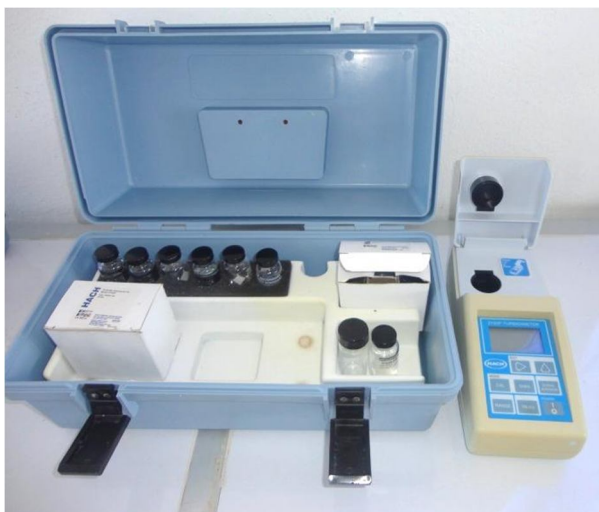
Fotografía N° 30: Equipo Turbidímetro HACH 2100P
