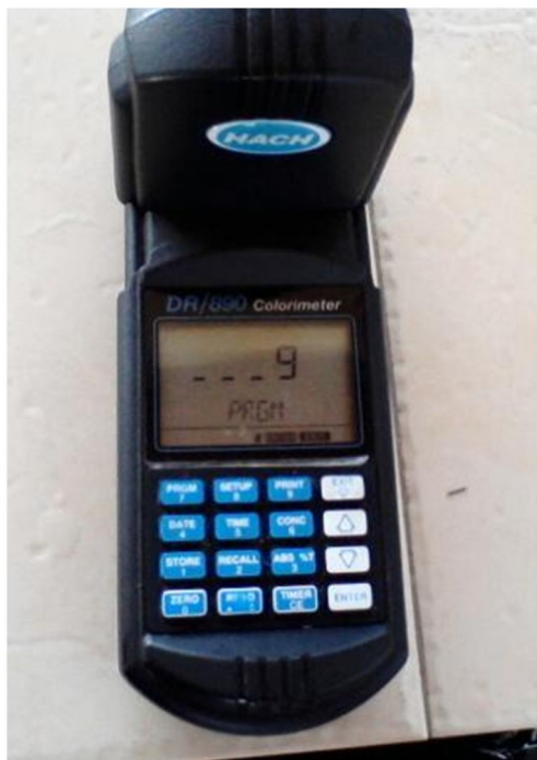
Fotografía N°25: Programación del Equipo HACH para determinación de Cloro Libre Residual (mg/L).
