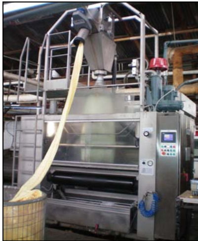
Fig. 3 Colocación de la tela tinturada en el equipo de alineado y suavizado. Fuente: El autor
