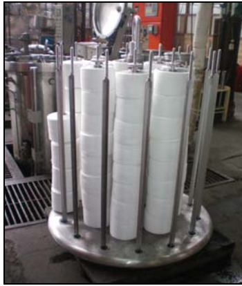
Fig. 9 Colocación del hilo a tinturar en el autoclave de tinturado. Fuente: El autor
