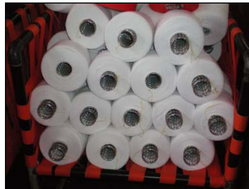
Fig. 8 Hilo a tinturar en los resortes metálicos.
