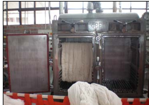
Fig. 2 Colocación del hilo a tinturar en el autoclave de tinturado. Fuente: El autor
