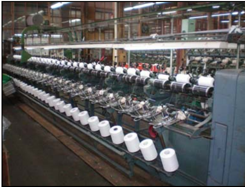
Fig. 11 Enconado del hilo tinturado. Fuente: El autor
