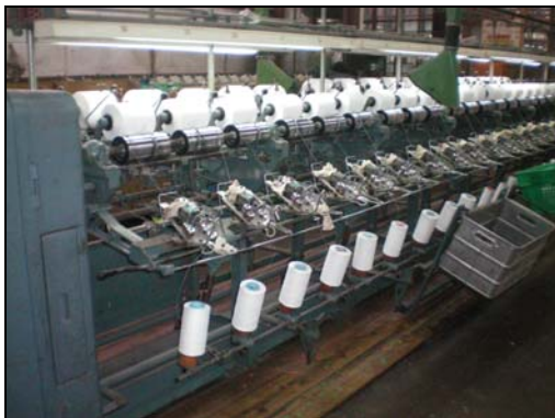
Fig. 7 Colocación del hilo a tinturar en los resortes metálicos.
