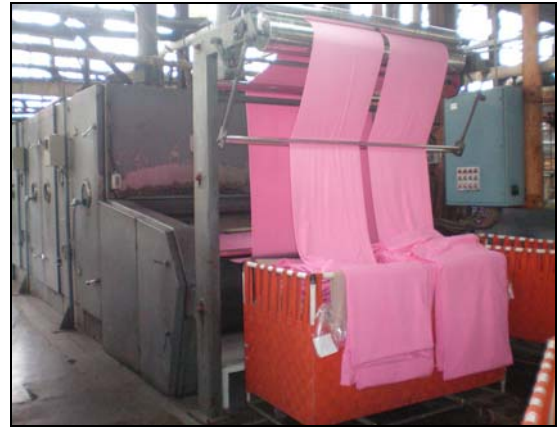
Fig. 6 Salida de la tela tinturada de la secadora. Fuente: El autor
