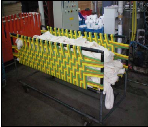
Fig. 1 Tela a tinturar, formación de la cuerda. Fuente: El autor
