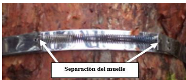
Figura 12. Dendrómetros artesanales. Las medidas correspondientes de incremento del diámetro del árbol se determinan a partir del incremento de separación entre los extremos de medida del dendrómetro en un periodo de tiempo determinado.
