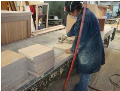
Imagen 64. Lijado de tableros.
