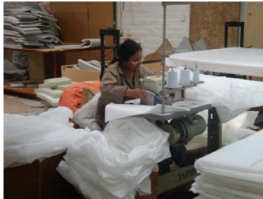
Imagen 52. Confeccionado de las fundas para los plumones.
