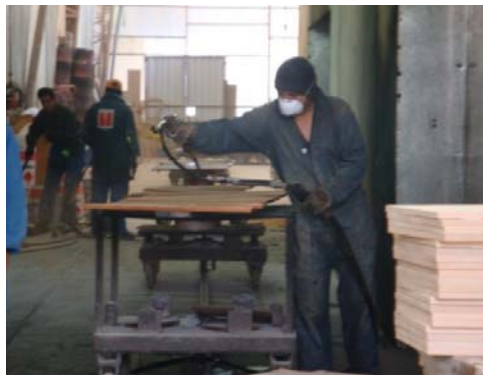
Imagen 29. Tinturado del mueble.
