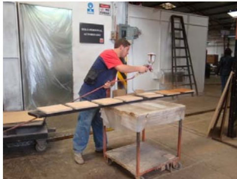
Imagen 66. Aplicación del tinte.
