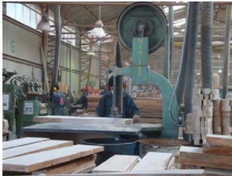
Imagen 22. Corte de piezas plantilladas.
