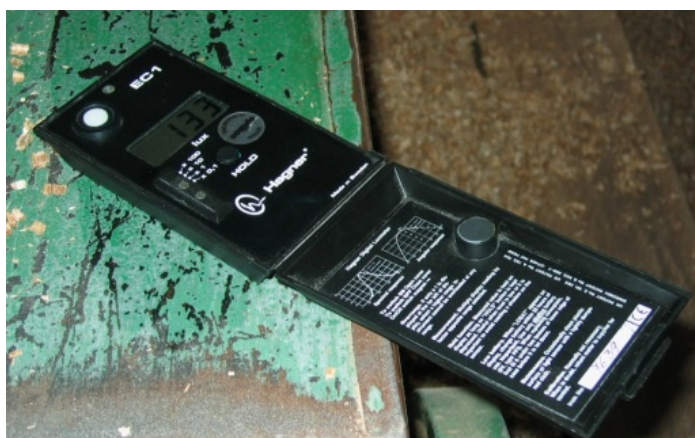
Foto # 4 Equipo de medición de luz (luxómetro digital marca Hagner EC1 con escala desde 0,1 hasta 10000 luxes). Área de de preparación y corte de materiales.
