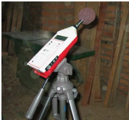
Foto # 1.- equipo de medición de ruido (sonómetro integrador de marca QUEST TECHNOLOGIES modelo 2900), zona de preparación inicial.
