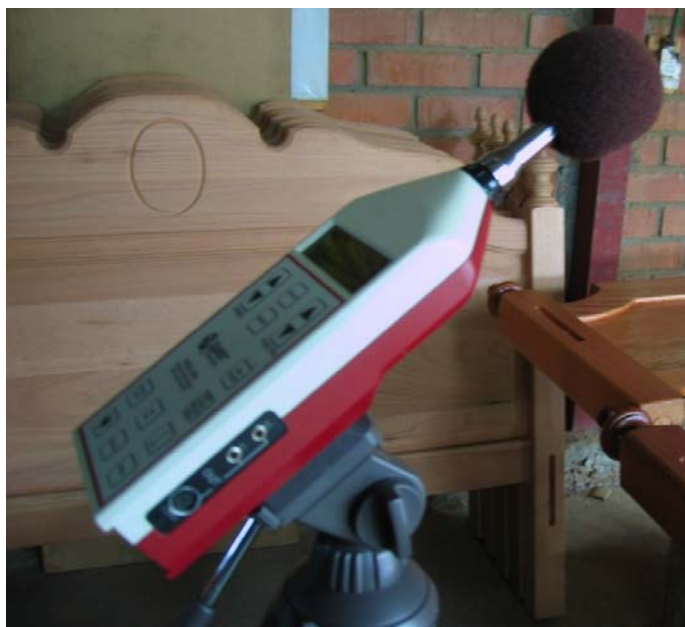
Foto # 3.- medición de ruido área de ensamblaje y acabado final.
