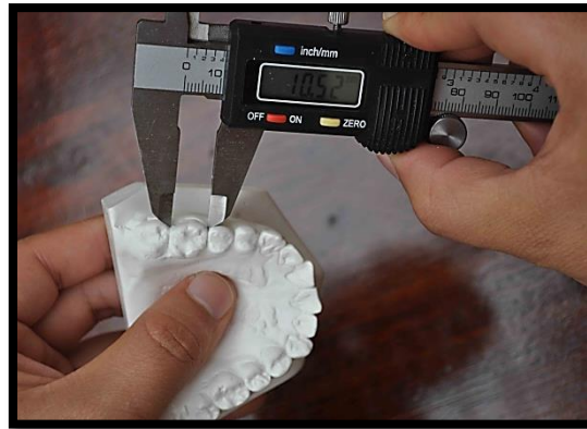
Fig. 20: Medición del diámetro mesiodistal con el calibrador digital
