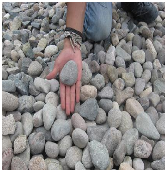
Fotografía 45. Izquierda: Material para primera capa. Derecha: Colocación de primera capa de material filtrante.
