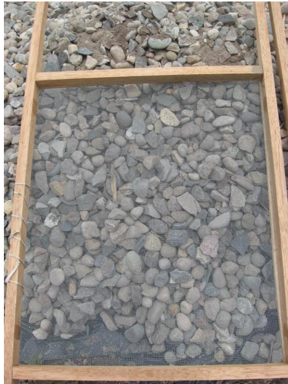
Fotografía 39. Tamiz para cuarta capa (arena gruesa) de material filtrante.
