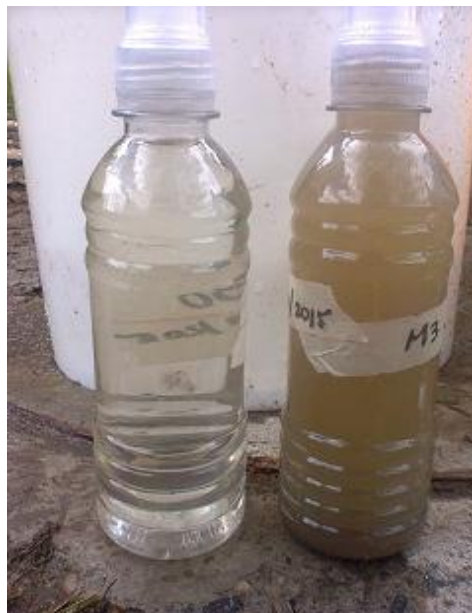
Fotografía 74. Comparación de Agua de salida (izquierda) y agua de entrada (derecha) del sistema.
