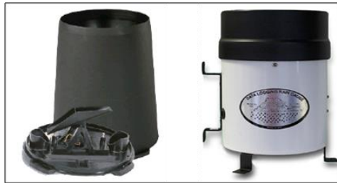
Figura 4. Pluviógrafos “Rain Collector II y HOBO datalogger”. Fuente (PROMAS, 2011)
