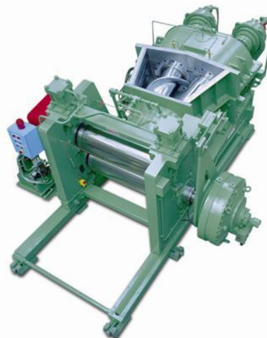
Figura 12: Molino del Mixer. Fuente: Cesar Vargas, (Farrel, 2015)
