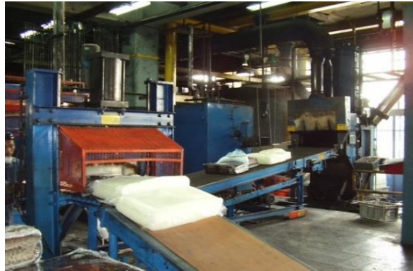
Figura 11: Ingreso de materia prima en el Mixer. Fuente: César Vargas – Proceso de fabricación de neumáticos.
