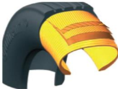
Figura 5: Estructura interna de un neumático Radial Fuente: Manual Tire Basic – Continental Tire Andina S.A.
