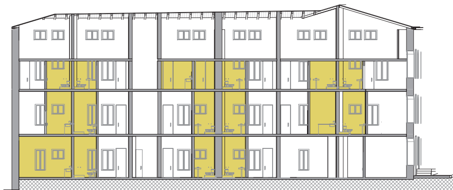
Figura 129. Sección 2-2 - Optimización de instalaciones_ áreas húmedas
