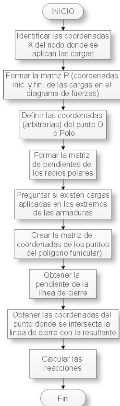
Diagrama de Bloques 1. Proceso general empleado en el cálculo de las reacciones con el método de Estática Gráfica.
