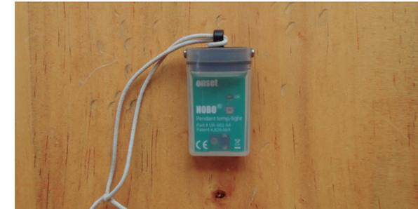
Imagen 2.15 - Sensor HOBO para mediciones interiores
