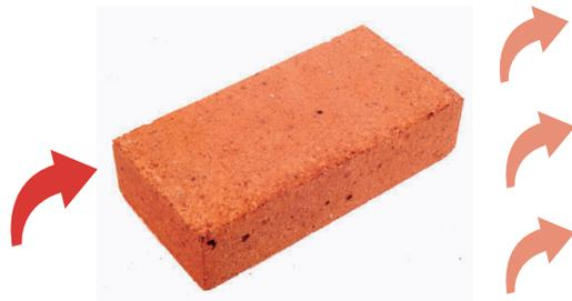
térmica. Este desfase depende de la conductividad térmica del material, de su densidad, del espesor, de su calor específico, y del tiempo. Debido a que la transferencia de calor a través de puertas y ventanas es prácticamente instantánea, debe conseguirse en lo posible que el desfase se produzca en los muros de cerramiento. (Climablock, 2014)
