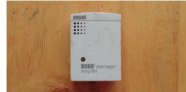
Imagen 2.16 - Sensor HOBO para mediciones interiores, canal doble
