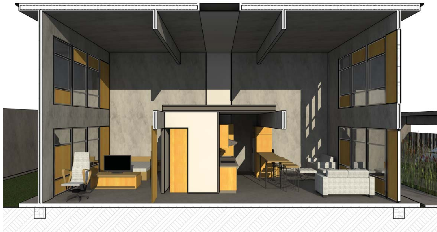
7. Esquema tridimensional del Corte B - B. Fuente: el Autor
