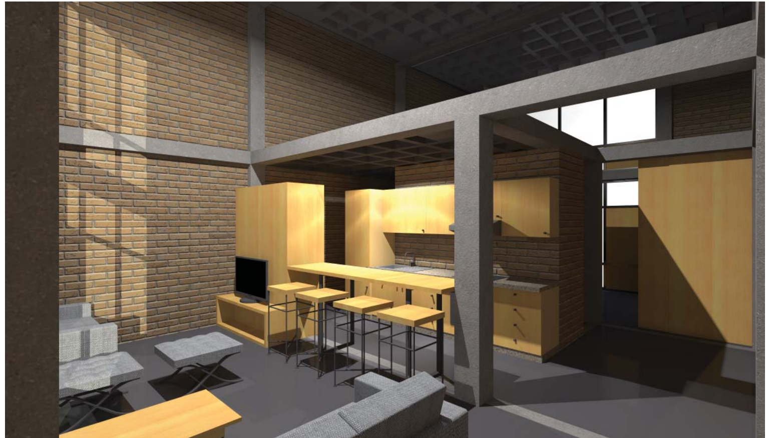
12. Perspectiva interior ambientada Módulo Pórticos de Hormigón Armado con Mampostería de Ladrillo. Fuente: el Autor
