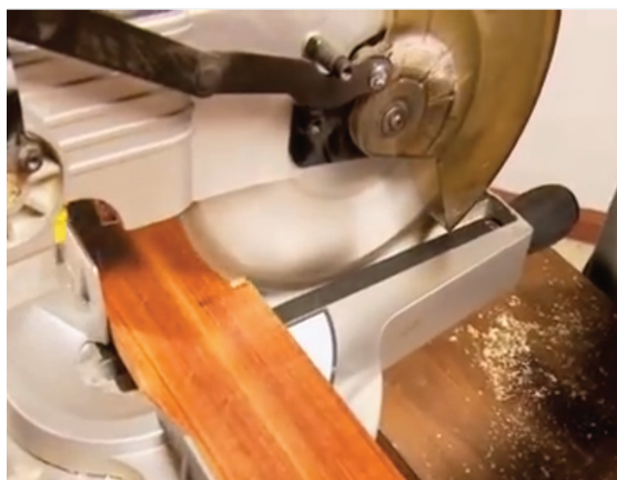
184. Atornillado de tiras de madera a losa de concreto, Cuenca-Ecuador (Capturado 2014, 02 de septiembre) 185. Corte de duelas, Cuenca-Ecuador (Capturado 2014, 02 de septiembre)
