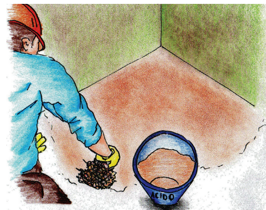
7. Colocación de ácido o material de coloración, se aplica con waípe o esponja.
