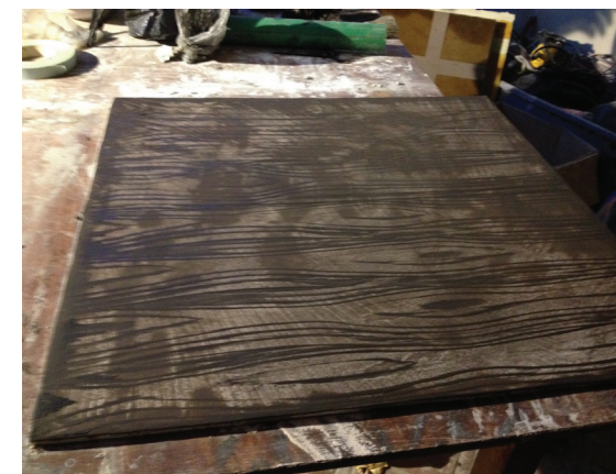
356. Estampado de color con envejecedor y agua. 357. Placa con estampado de color simulando madera.
