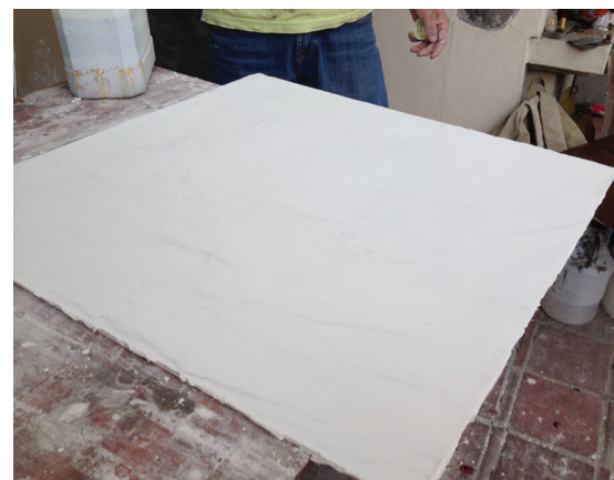
364. Mezcla de microcemento con agua y Permácril. 365. Placa de fibrocemento con capas de microcemento blanco.
