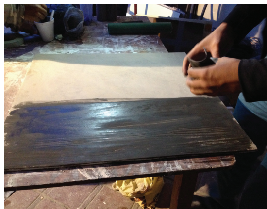
354. Placa con capa de microcemento seca, lijada y limpia. 355. Coloración de placa con mezcla de envejecedor y agua.
