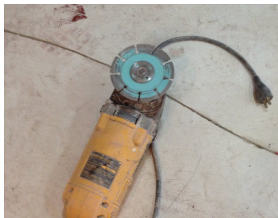
263. Elaboración de juntas de dilatación, Restaurante La Tórtola, Cuenca-Ecuador (Capturado 2014, 18 de abril) 264. Elaboración de juntas de dilatación, Restaurante La Tórtola, Cuenca-Ecuador (Capturado 2014, 18 de abril)
