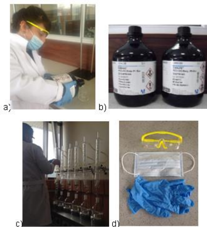
Figura 20. Preparación de solvente. (a)Volúmen. (b)Solventes. (c)Colocación de solvente en equipo Soxhlet. (d)Equipo de protección.
