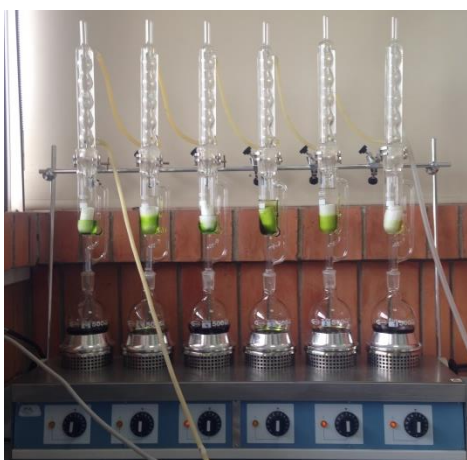
Figura 22. Equipo Soxhlet ensamblado para extracción.
