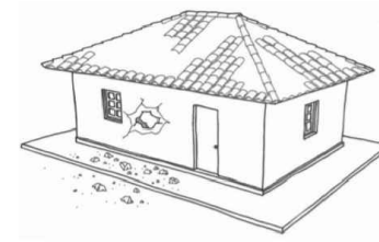
DESMORONAMIENTO PUNTUAL EN MURO
