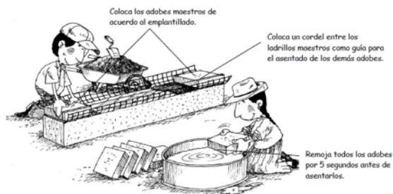
CONSTRUCCIÓN PRIMERA HILADA. FUENTE: AL "MANUAL DE CONSTRUCCIÓN DE ADOBE CON GEOMALLAS DE VIVIENDAS DE BAJO COSTO SALUDABLES Y SEGURAS" DE LA PONTIFICA UNIVERSIDAD CATÓLICA
