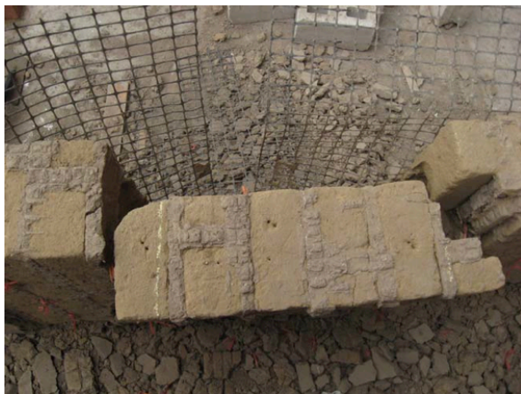
Grietas presentadas en las juntas en la zona central por flexión y en la lateral por corte Fuente: DISEÑO SISMICO DE MUROS DE ADOBE REFORZADOS CON GEOMALLA, DANIEL TORREALVA, SEPTIEMBRE 2009
