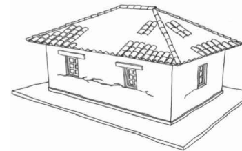
FISURA O GRIETA HORIZONTAL EN LA PARTE INFERIOR DE VENTANA
