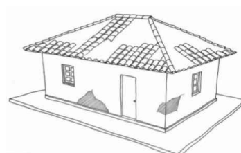
DESPRENDIMIENTO O EROSIÓN DE REVOQUE
