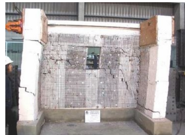
Muro de adobe con refuerzo y sin revoque en ensayo cíclico horizontal
