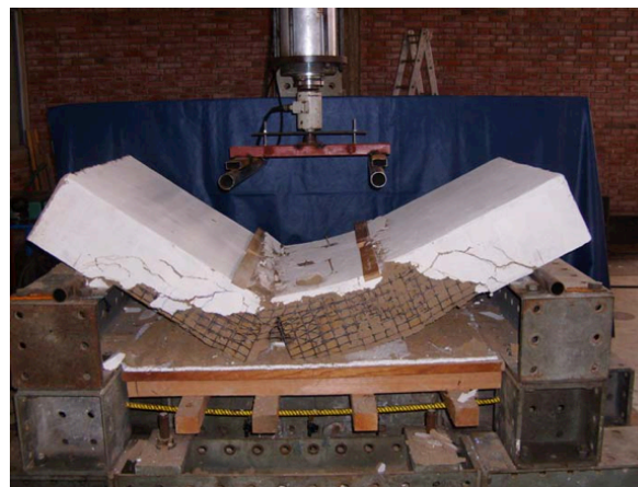
Falla en flexión por rotura de la geomalla en tracción
