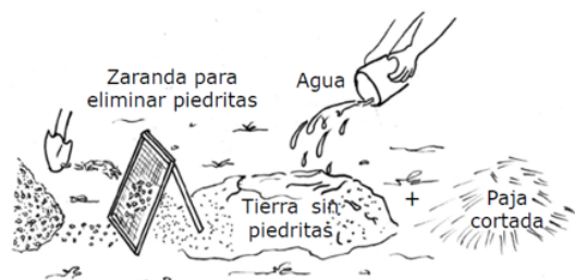
Preparación de revoque de barro. Fuente: Casas sismorresistentes y saludables de adobe reforzado con geomallas Zona de la costa. Pontificia Universidad Católica del Perú, 2007
