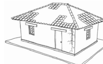
FISURA O GRIETA VERTICAL EN ESQUINA DE MUROS
