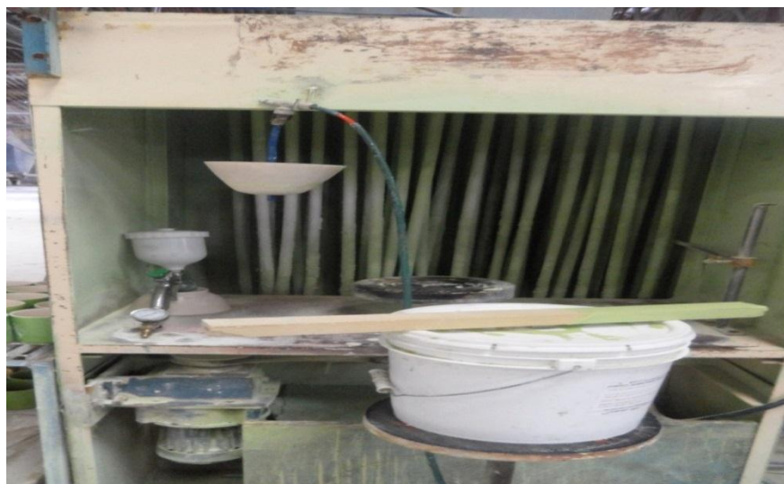
Gráfica 3. Coloreado exterior por inmersión (mayólica) fotografía 1
