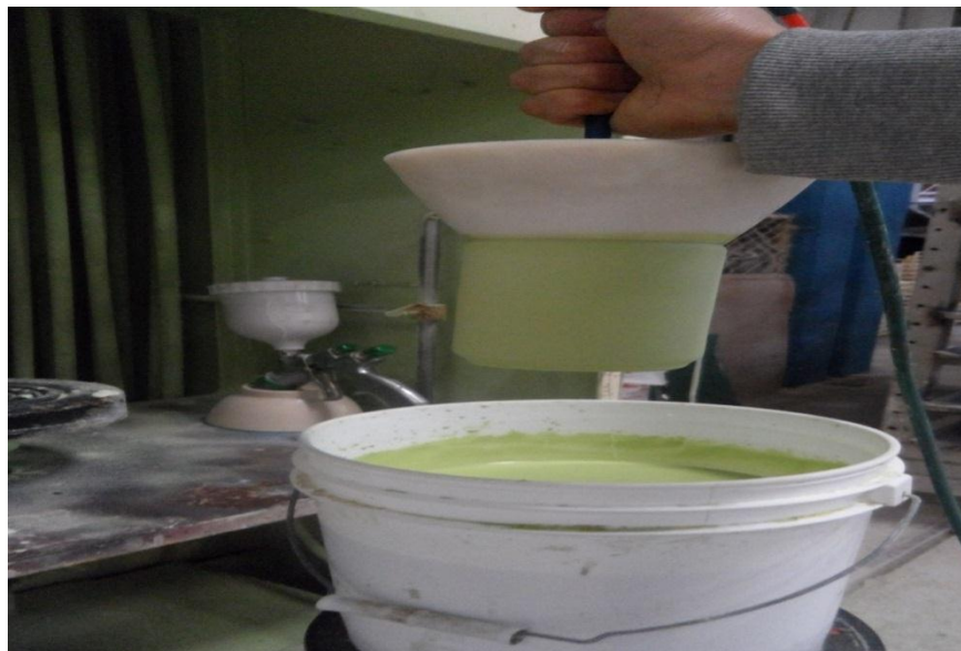
Gráfica 5. Coloreado exterior por inmersión (mayólica) fotografía 3
