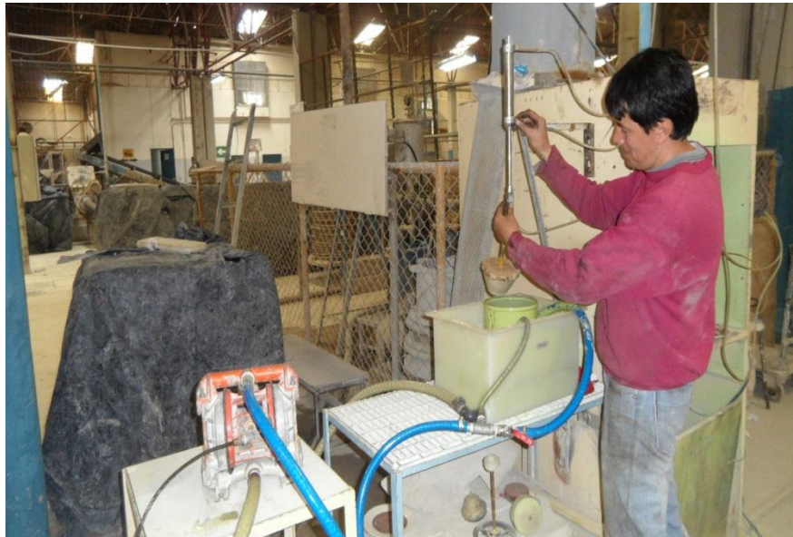
Gráfica 12. Inmersión en esmalte de producción fotografía 3
