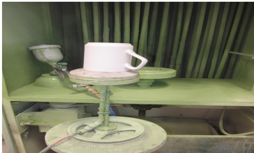
Gráfica 7. Coloreado exterior por aspersión fotografía 1
