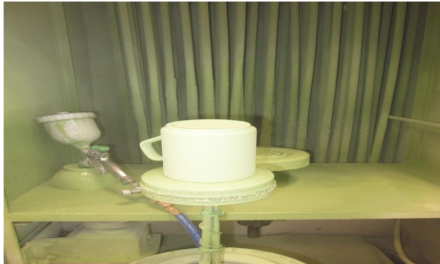
Gráfica 8. Coloreado exterior por aspersión fotografía 2
