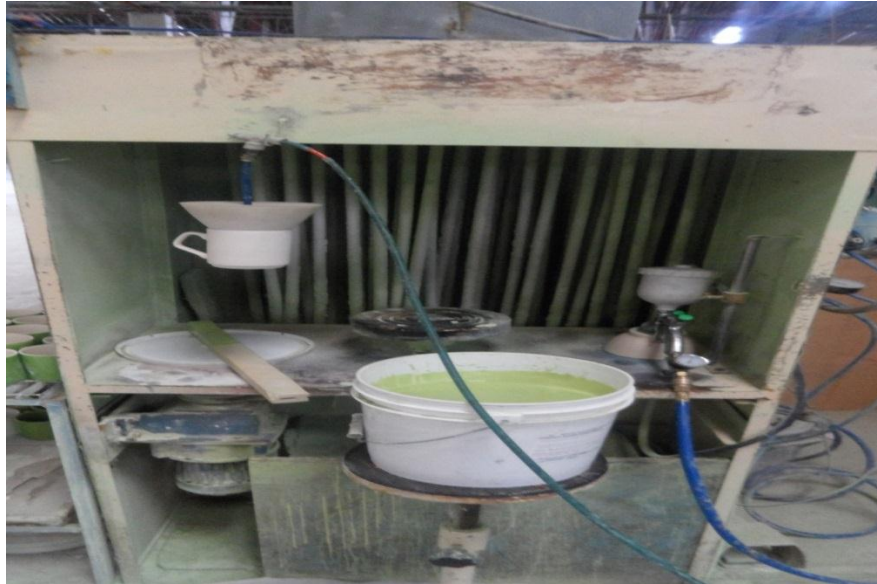
Gráfica 4. Coloreado exterior por inmersión (mayólica) fotografía 2
