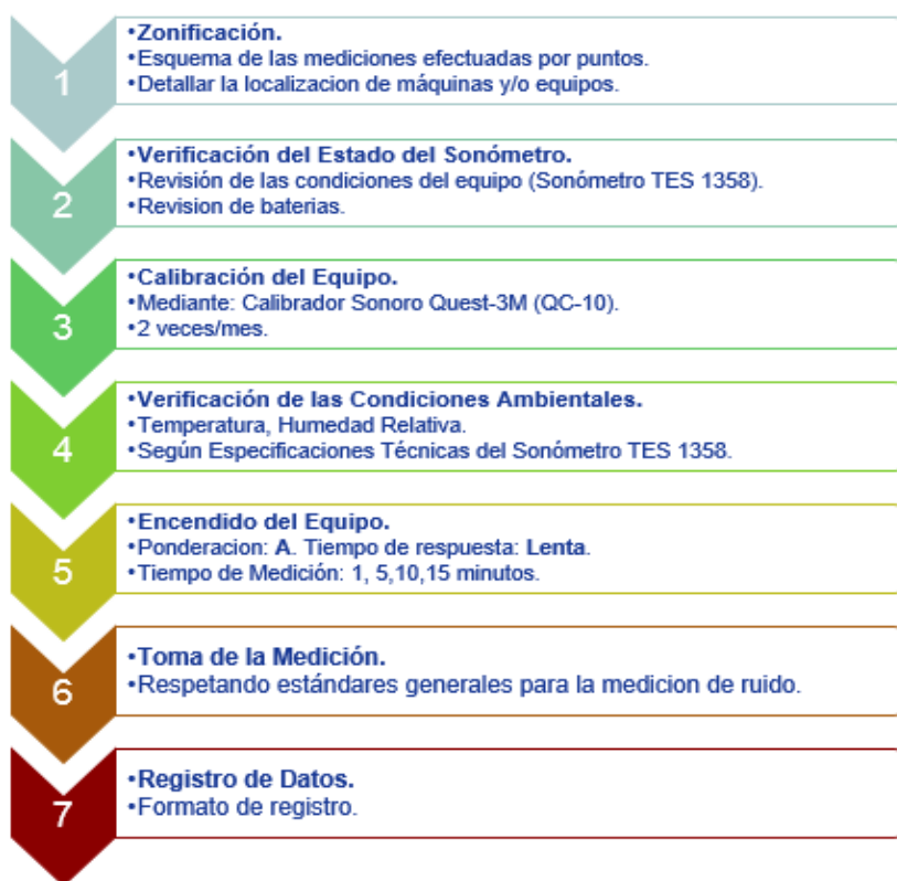
Figura 7.2. Esquema del procedimiento general de medición del ruido.
