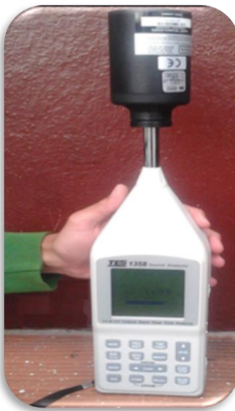
Fotografía 7.5. Calibración del Sonómetro TES 1358.
