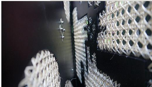
el sistema de unión con **botones automáticos (machimbrado)** requiere de dos módulos: en uno de ellos se colocaron las partes negativas (con cavidad - hembra) y en el otro módulo las partes positivas (con mas relieve - macho)
