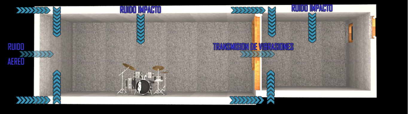
GRÁFICO 099 ESQUEMA DEL COMPORTAMIENTO DEL SONIDO QUE SE TRANSMITE AL INTERIOR DE LOS ESPACIOS. Fuente: MIGUEL PULLA G. Elaboración: Archivo de Tesis.
