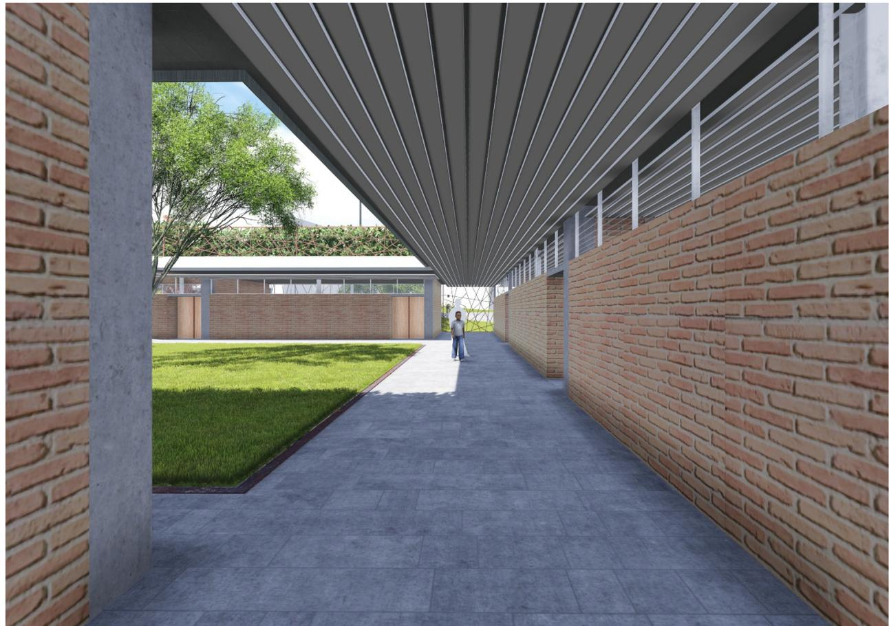
52. Estructura vista de hormigón, tabiquería de ladrillo panelón, cielo raso y carpinterías de aluminio
