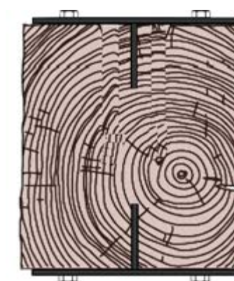
Figura 4.9. Refuerzo con doble platina T, ubicadas en las caras inferior y superior. / Fuente: Daniel Enríquez M.
