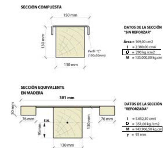
Figura 4.40. Definición del factor de corrección "K", para el sistema de perfil C. / Fuente: Daniel Enríquez M.
