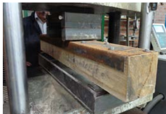
Figura 4.34. Montaje para ensayo a flexión de Probeta L8. / Fuente: Daniel Enríquez M.
