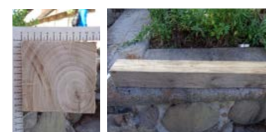
Figura 2.35. Probeta Libre, muestra de eucalipto nuevo. Izq.: Sección transversal. Der.: Longitud total. / Fuente: Daniel Enríquez M.
