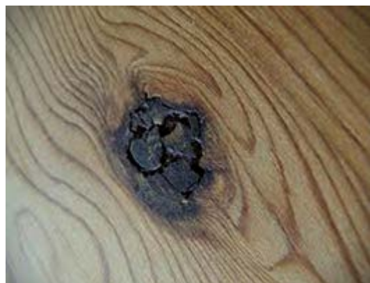
Figura 1.22. Nudo Muerto o perforación en Madera Aserrada / Fuente: Defectos de la Madera. http://bricolaje.facilísimo.com/foros/restauracion/preparar-bancos-de-madera-para-el-exterior_775797_2.html
