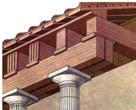
Figura 1.4. Tipología de Cubierta en Madera de los templos Griegos. Cubierta del Arsenal de Atenas. / Fuente: mariafernandahappy.webnode.es/arquitectura-griega/periodos/periodo-arcaico/
