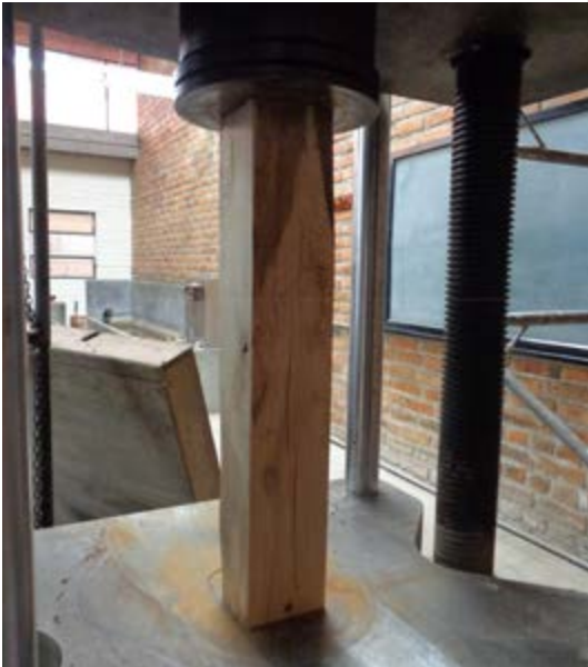
Figura 2.53. Estado de la probeta F2 después del ensayo a compresión. / Fuente: Daniel Enríquez M.
