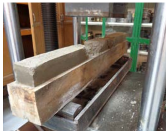
Figura 3.28. Estado de la probeta L6, después de realizar en ensayo. Fuente: Daniel Enríquez M.
