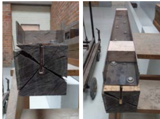
Figura 3.24. Izq.: Sección de Probeta reforzada con perfil metálico C. Der.: Colocación de tirafondos en doble fila al tresbolillo. Fuente: Daniel Enríquez M.
