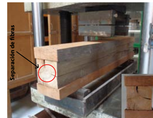
Figura 3.22. Estado de la probeta L4, con refuerzos de madera, después del ensayo. Fuente: Daniel Enríquez M.
