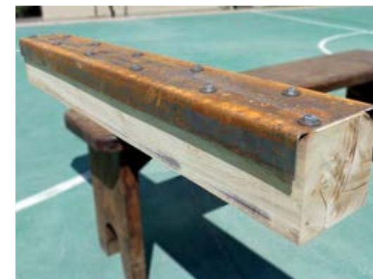
Figura 4.33. Probeta L8 reforzada con un perfil metálico "C". / Fuente: Daniel Enríquez M.
