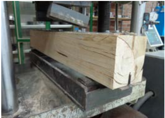
Figura 4.26. Montaje para ensayo a flexión de Probeta L7. / Fuente: Daniel Enríquez M.
