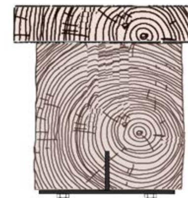
Figura 4.12. 1° Reforzamiento estructural mixto. Sistema mediante una pieza de madera (cara superior), más una platina metálica "T" (cara inferior). / Fuente: Daniel Enríquez M.
