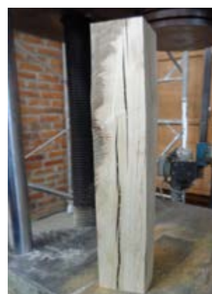
Figura 2.49. Probeta F2, L=60cm. Muestra de eucalipto antiguo 50 años. / Fuente: Daniel Enríquez M.
