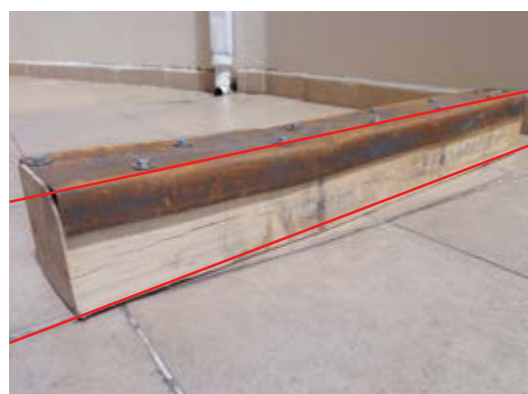
Figura 4.39. Deformación de la probeta L7, después del ensayo. / Fuente: Daniel Enríquez M.
