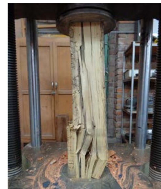
Figura 2.51. Estado de la probeta A1 después del ensayo a compresión. / Fuente: Daniel Enríquez M.
