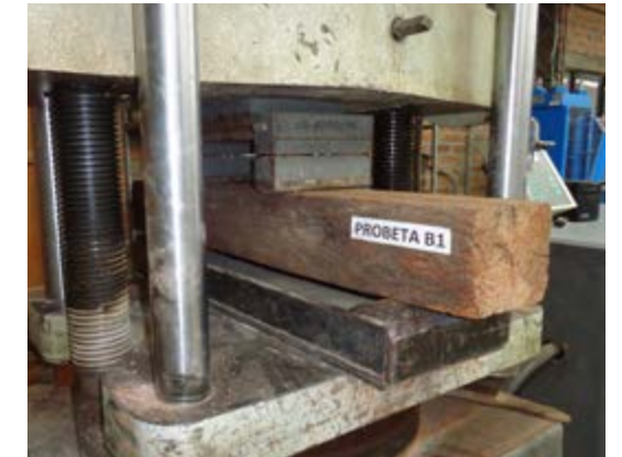
Figura 2.36. Montaje para ensayo a flexión. Probeta B1. / Fuente: Daniel Enríquez M.
