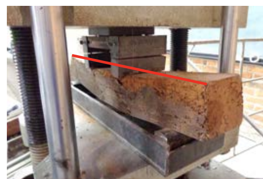
Figura 2.17. Probeta de madera deformada más de 3cm., después de realizar un ensayo a flexión. / Fuente: Daniel Enríquez M.
