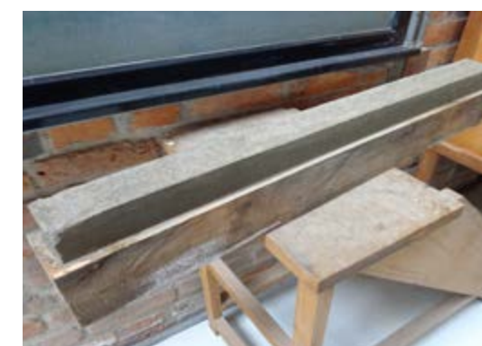
Figura 3.20. Probeta de eucalipto reforzada mediante hormigón por su cara superior. Fuente: Daniel Enríquez M.
