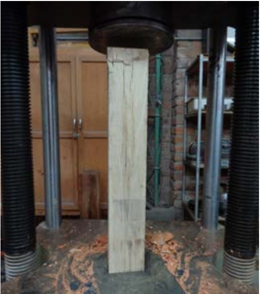
Figura 2.55. Estado de la probeta L2 después del ensayo a compresión. / Fuente: Daniel Enríquez M.
