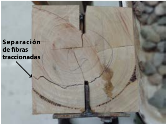
Figura 4.27. Sección de la Probeta L7, después del ensayo. / Fuente: Daniel Enríquez M.
