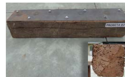
Figura 2.60. Probeta B2 reforzada. Izq.: Longitud total con platina metálica. Der.: Sección de la probeta reforzada./ Fuente: Daniel Enríquez M.
