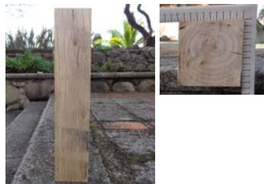
Figura 2.50. Probeta L2, L=60cm. Muestra de eucalipto nuevo. Izq.: Longitud total. Der.: Sección transversal. / Fuente: Daniel Enriquez M.
