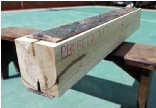
Figura 4.25. Probeta L7 reforzada con doble platina metálica tipo “T”. / Fuente: Daniel Enríquez M.
