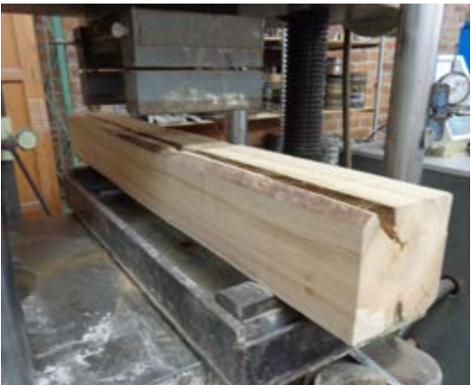
Figura 2.40. Montaje para ensayo a flexión. Probeta F1. / Fuente: Daniel Enríquez M.
