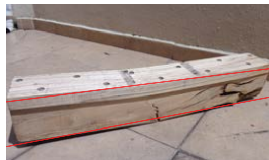
Figura 4.48. Deformación permanente de la probeta C, después del ensayo. / Fuente: Daniel Enríquez M.
