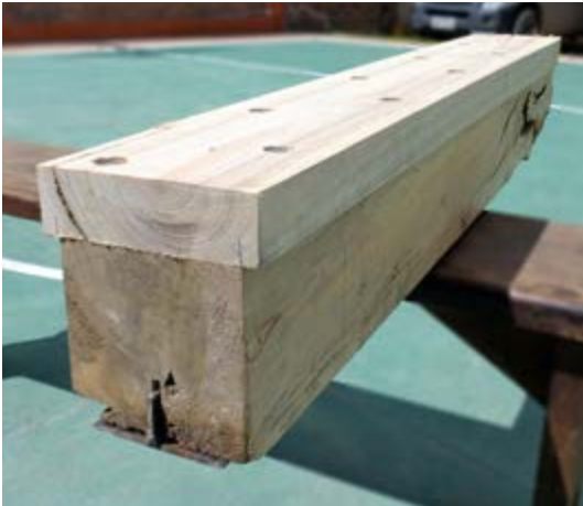
Figura 4.42. Madera con 100 años de antigüedad. Probeta “C”, reforzada con una pieza de madera y una platina metálica “T”. / Fuente: Daniel Enríquez M.
