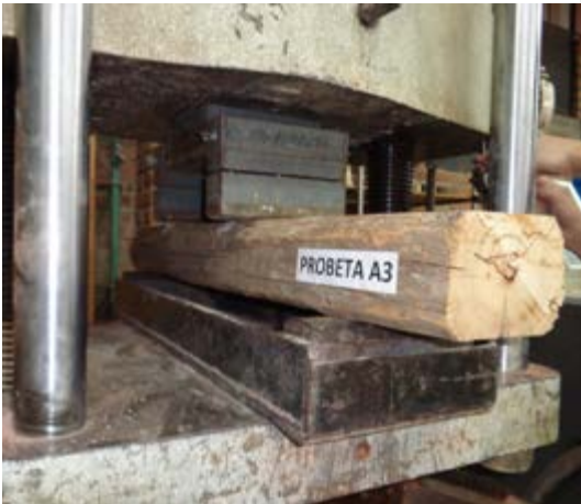
Figura 2.38. Montaje para ensayo a flexión. Probeta A3. / Fuente: Daniel Enríquez M.
