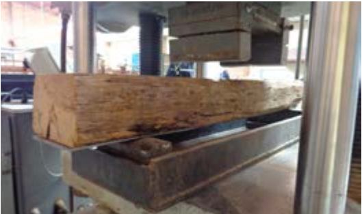
Figura 2.64. Estado de la probeta A2 después del ensayo a flexión. / Fuente: Daniel Enríquez M.
