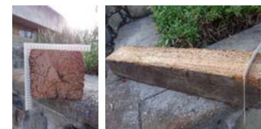
Figura 2.32. Probeta B1, muestra de madera desconocida, 100 años. Izq.: Sección transversal. Der.: Longitud total. / Fuente: Daniel Enríquez M.
