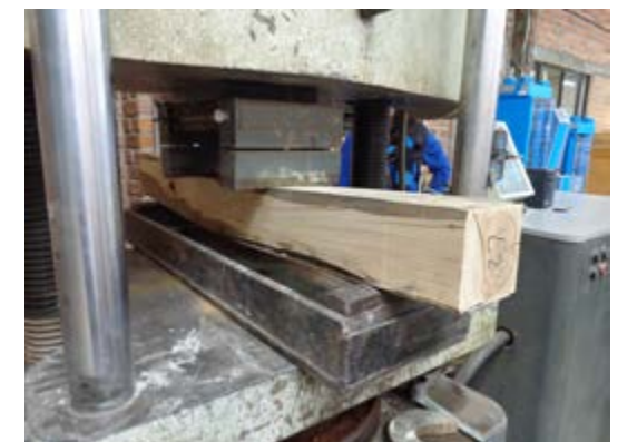
Figura 2.66. Estado de la probeta F3 después del ensayo a flexión. / Fuente: Daniel Enríquez M.
