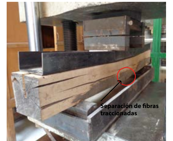
Figura 3.25. Estado de la probeta L5, con refuerzos mediante perfiles metálicos, después del ensayo. Fuente: Daniel Enríquez M.
