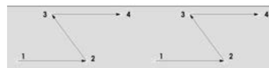
Figura 2.59. Disposición de los tirafondos y secuencia de apriete en zig-zag./ Fuente: Daniel Enríquez M.
