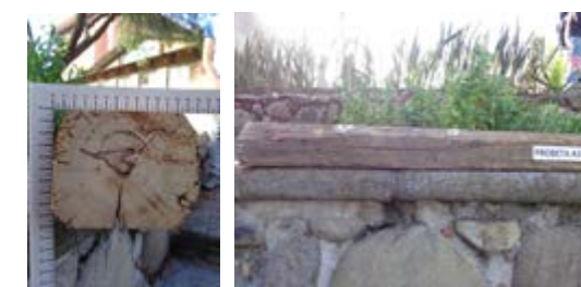
Figura 2.33. Probeta A3, muestra de eucalipto antiguo, 100 años. Izq.: Sección transversal. Der.: Longitud total. / Fuente: Daniel Enríquez M.
