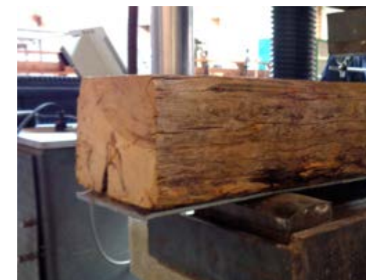
Figura 4.5. Fijación deficiente entre madera y platina metálica. / Fuente: Daniel Enríquez M.
