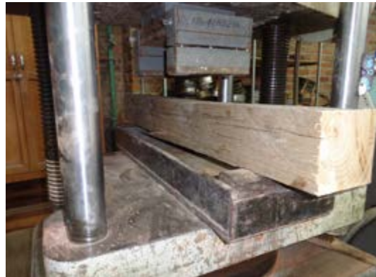
Figura 2.42. Montaje para ensayo a flexión. Probeta nueva L1. / Fuente: Daniel Enríquez M.
