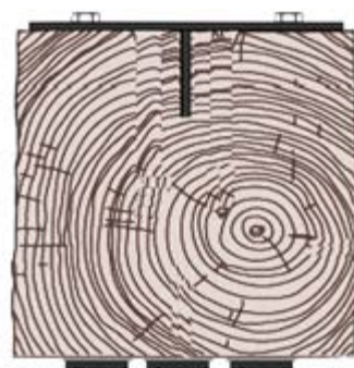
Figura 4.14. 3º Reforzamiento estructural mixto. Sistema mediante una platina metálica "T" (cara superior), más tres fibras de carbono (cara inferior). / Fuente: Daniel Enríquez M.
