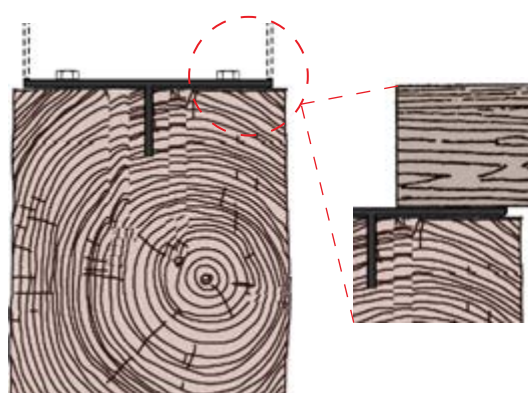
Figura 4.8. Optimización de perfil "C", en una platina "T", mejorando el área de asentamiento. / Fuente: Daniel Enríquez M.
