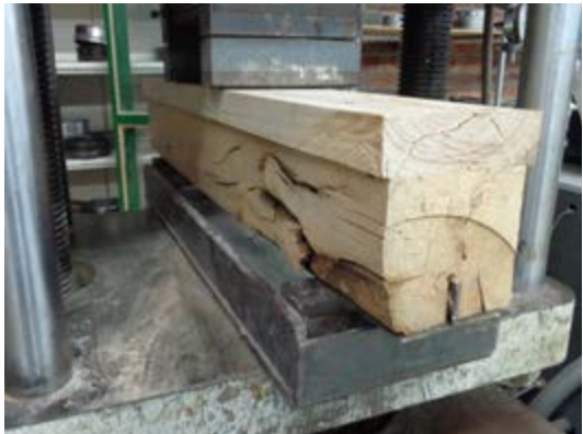
Figura 4.44. Montaje para ensayo a flexión de Probeta C. / Fuente: Daniel Enríquez M.
