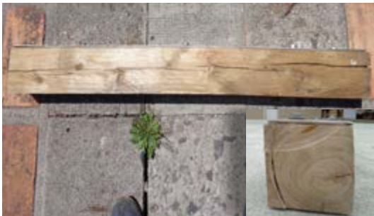
Figura 2.62. Probeta L3 reforzada. Izq.: Longitud total con platina metálica. Der.: Sección de la probeta reforzada./ Fuente: Daniel Enríquez M.
