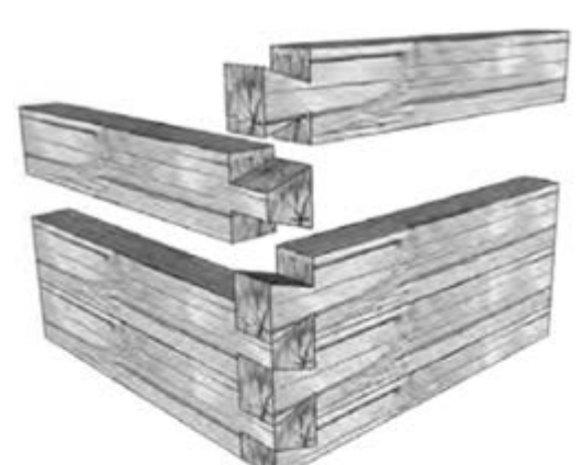
Rollizo labrado con unión cola de milano
