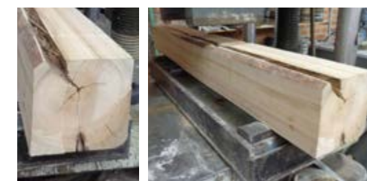
Figura 2.34. Probeta F1, muestra de eucalipto antiguo, 50 años. Izq.: Sección transversal. Der.: Longitud total. / Fuente: Daniel Enríquez M.
