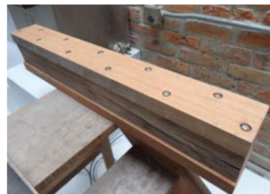
Figura 3.18. Probeta de eucalipto reforzada mediante tabloncillos de madera. Fuente: Daniel Enríquez M.
