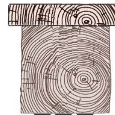
Figura 4.13. 2° Reforzamiento estructural mixto. Sistema mediante una pieza de madera (cara superior), más tres fibras de carbono (cara inferior). Fuente: Daniel Enríquez M.
