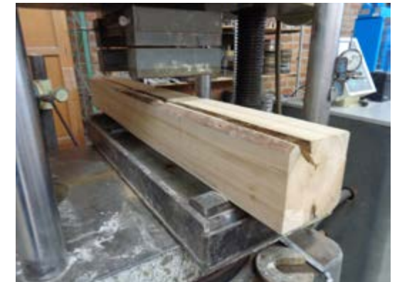
Figura 2.65. Estado de la probeta F3 después del ensayo a flexión. / Fuente: Daniel Enríquez M.
