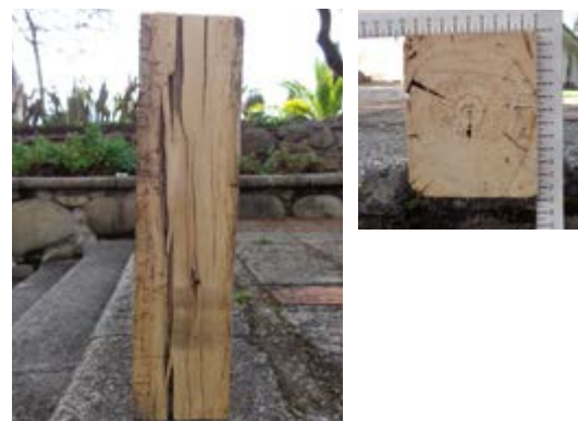
Figura 2.48. Probeta A1, L=60cm. Muestra de eucalipto antiguo 100 años. Izq.: Longitud total. Der.: Sección transversal. / Fuente: Daniel Enríquez M.
