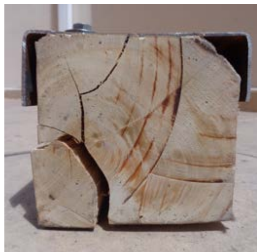
Figura 4.38. Sección de la probeta L8, después del ensayo. / Fuente: Daniel Enríquez M.
