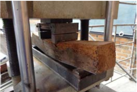
Figura 2.63. Estado de la probeta B2 durante el ensayo a flexión / Fuente: Daniel Enríquez M.
