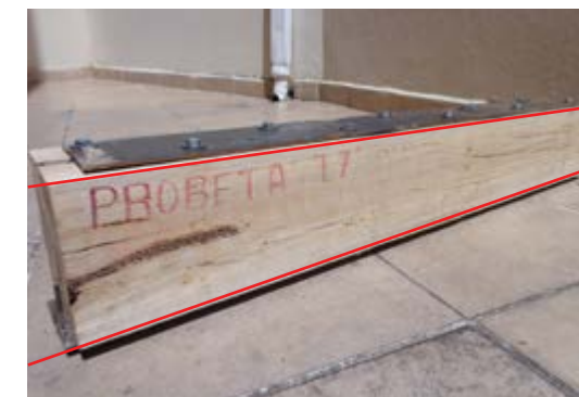
Figura 4.30. Deformación de la probeta L7, después del ensayo. Fuente: Daniel Enríquez M.
