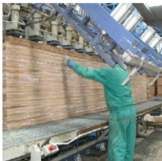
Figura 1.94. Elaboración de una viga recta con madera laminada. Laminados villapol-España/ Fuente: http://www.cismadeira.com/castelan/proyectos/perfiles.htm
