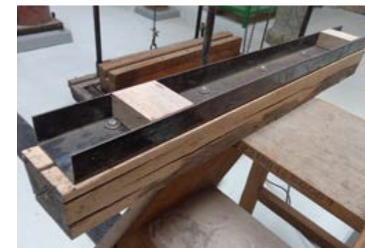
Figura 3.19. Probeta de eucalipto reforzada mediante perfil metálico tipo "C" y platina por la cara superior. Fuente: Daniel Enríquez M.
