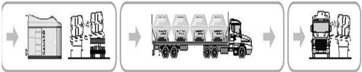
Ilustración 5.6: Gasoducto Virtual: Estación Madre, Transporte de los Módulos de almacenamiento y Estación hija.
