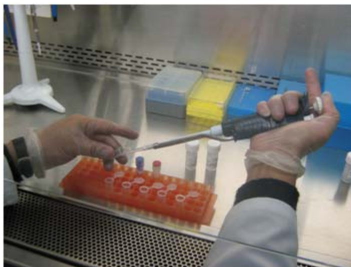
Cámara de flujo laminar
