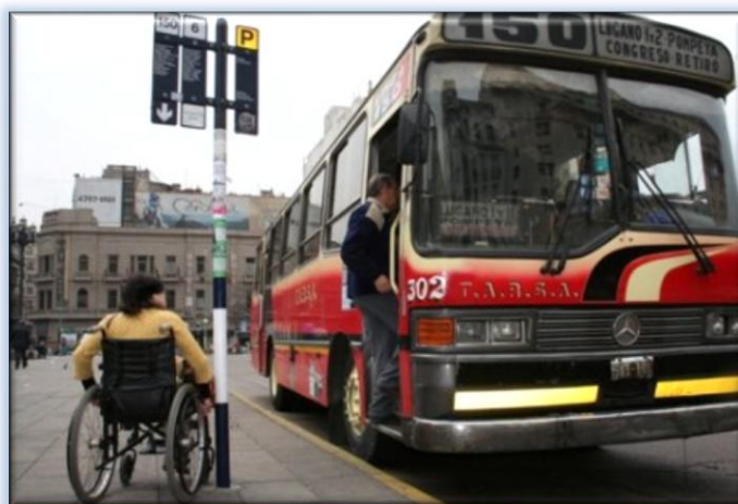
Ilustración 45: Inexistencia del mecanismo de plataforma.
